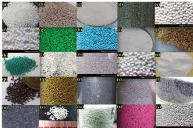
▲ Hình 2. Hình ảnh các loại sản phẩm thu hồi bằng công nghệ FBHC từ các nguồn nước thải khác nhau (Nguồn: Lê Văn Giang, 2022)
