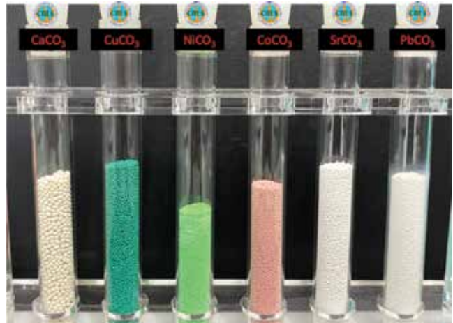
▲ Hình 4. Các sản phẩm thu hồi từ các nguồn nước thải khác nhau bằng công nghệ FBHC (Nguồn: Viện Tài nguyên và Môi trường, 2022)
