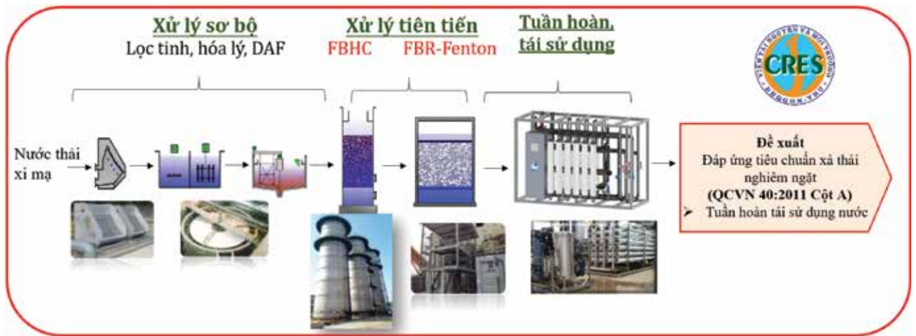
▲ Hình 5. Quy trình xử lý nước thải xi mạ theo hướng thu hồi tài nguyên và tuần hoàn nước (Nguồn: Viện Tài nguyên và Môi trường, 2023)
