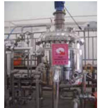
▲ Hình 3. Thiết bị phản ứng dung tích 800l
