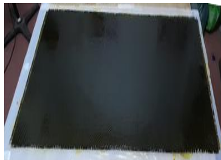
Hình 2. Prepreg nhựa nền phenolic/ cốt vải cacbon
