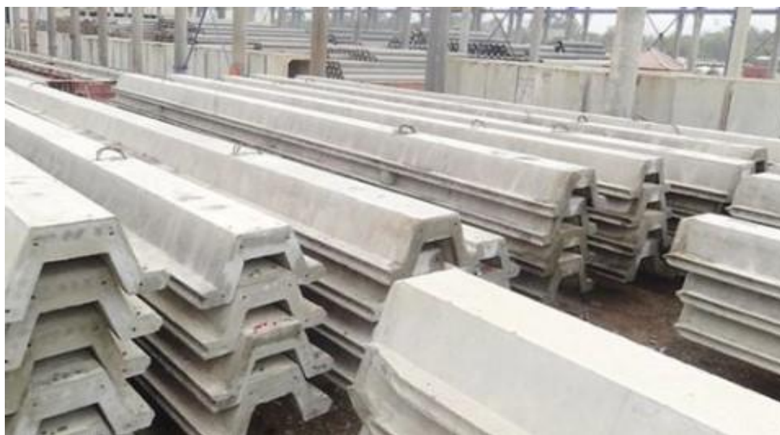
Hình 2. Cọc cừ SW840 dùng cho công trình kè bờ
