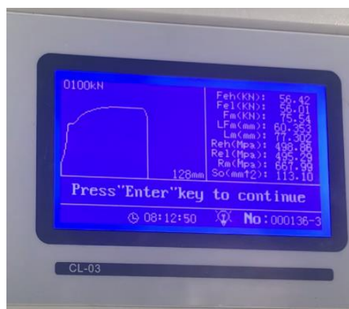
Hình 9. Màn hình kết quả thí nghiệm kéo thanh thép mẫu D12 với tốc độ gia tải 3,0kN/s
