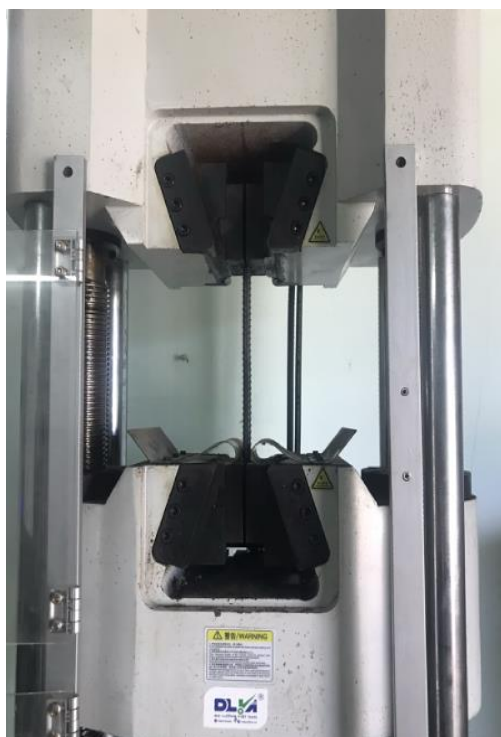
Hình 5. Cố định mẫu thử trên máy kéo bằng mâm kẹp (ảnh chụp khi các tấm bảo hộ được mở)
