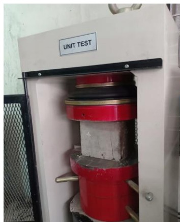
Hình 4: Thí nghiệm nén mẫu bê tông
