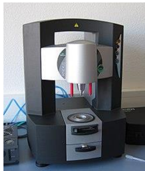
Hình 3: Máy đo lưu biến dạng xi lanh quay trong phòng thí nghiệm [6].
